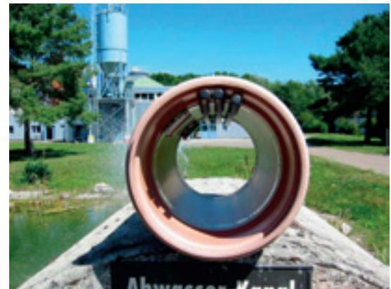
▲ Ein Musterstück zeigt, wie Halterungen und Leerrohre für Glasfaserkabel im Kanal befestigt werden
