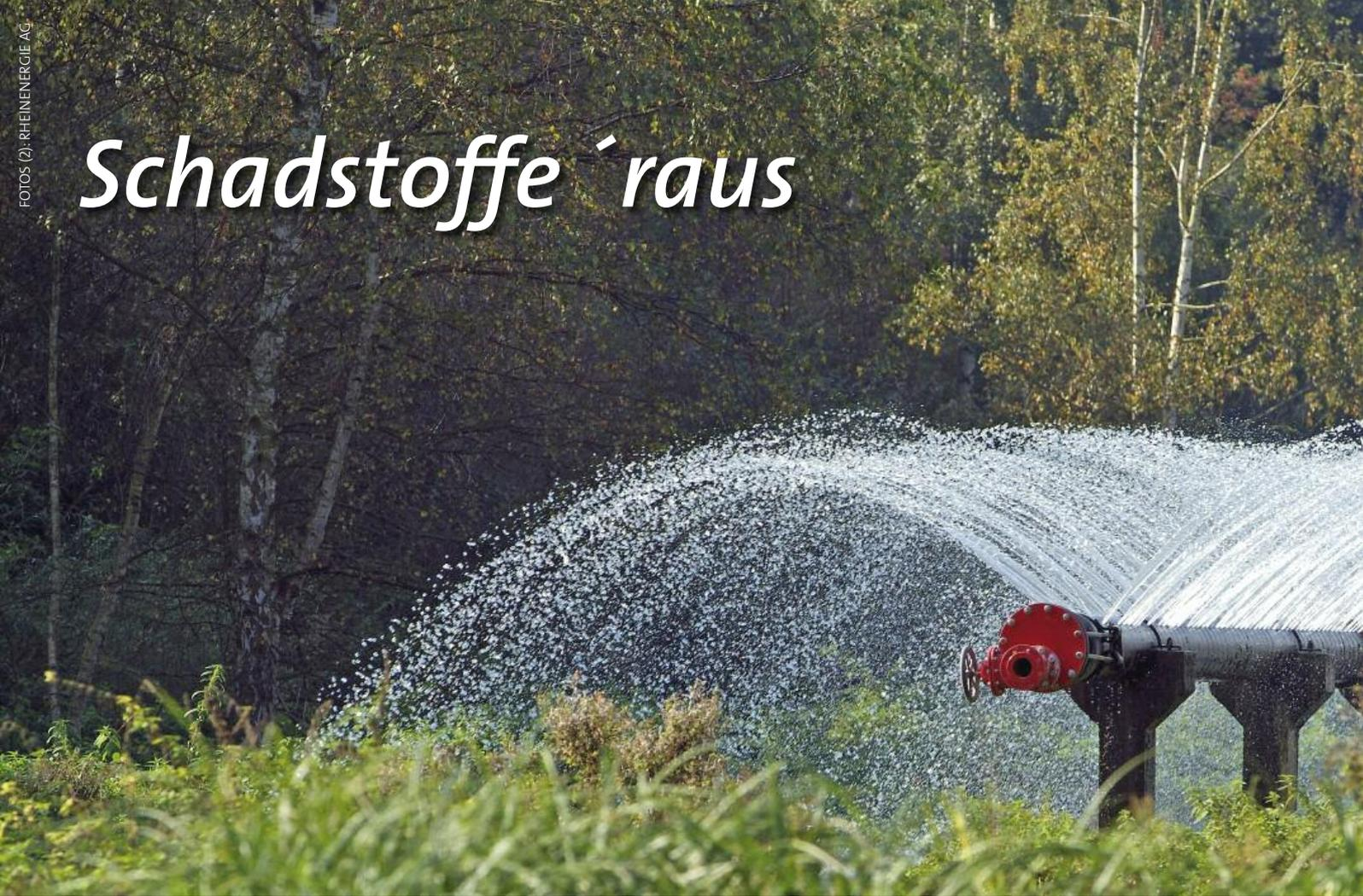
▲ Grundwasseranreicherung durch Verregnung ist in Nordrhein-Westfalen ein bewährtes Verfahren der Trinkwassergewinnung
