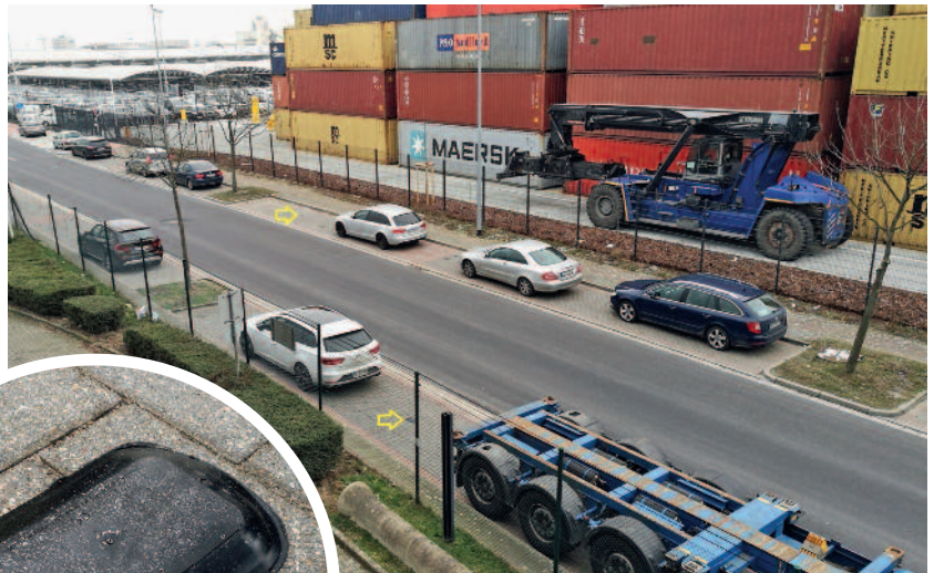
Die in den Parkbuchten aufgeklebten Parksensoren (links) können den ruhenden Verkehr nur richtig erfassen, wenn die Fahrzeuge korrekt abgestellt sind (oben)
